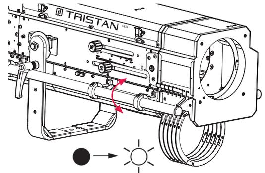
**Schritt 4** - Der Zoom- und Fokus des Lichtstrahls können mit den Einstellknöpfen A und B eingestellt werden.
