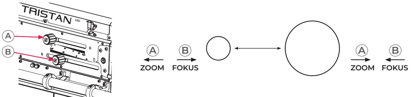
**Schritt 5** - Die Strahlgröße kann mit dem Irisgriff angepasst werden.
